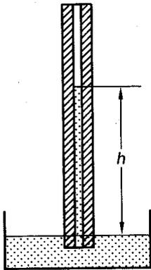
Benetzende Flüssigkeiten steigen in engen Röhren – gegen die Gravitationskraft – nach oben. Verantwortlich für diese Kapillarwirkung ist die Oberflächenspannung  $\sigma$ . Experimentell kann die Oberflächenspannung aus der kapillaren Steighöhe; dem Radius der Kapillare, der Dichte der Flüssigkeit und der Fallbeschleunigung bestimmt werden. Es gilt die Beziehung
