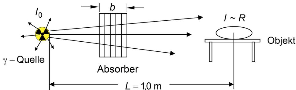
In einem Versuch wurden die Zählraten  $R$  (gemessen in Impulsen pro Minute „ipm“) in Abhängigkeit von der Dicke  $b$  der Bleiabschirmung gemessen :
