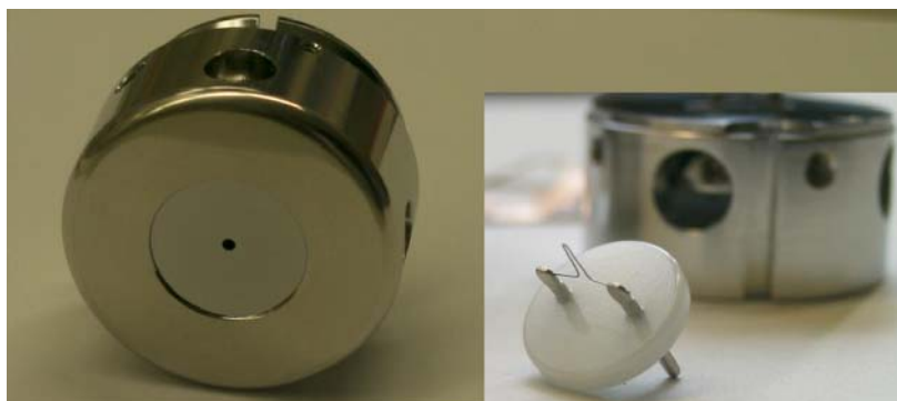
Abbildung 2: Wehneltzylinder und Wolframkathode
