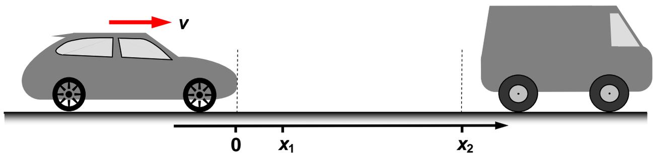
Nachfolgend wird angenommen, dass das Auto vor der Bremsung mit der Geschwindigkeit  $v = 130 \text{ km/h}$  fährt. Die Zeitspanne zwischen Erkennen der Situation durch den Fahrer bei Position  $x = 0$  und Einsetzen der Bremswirkung (Reaktionszeit) bei  $x = x_1$  beträgt  $t_R = 1,1 \text{ s}$ .
