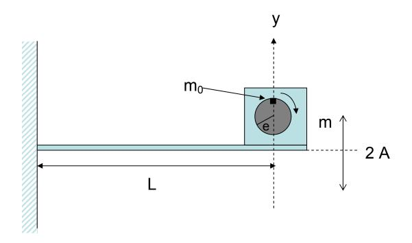
Auf einem einseitig eingespannten Stahlträger mit konstantem Querschnitt, Länge L=0,4m und dem Flächenmoment  $I_F$ =1,2  $10^{-11}$  m<sup>4</sup> ist ein Elektromotor mit der Masse m montiert (siehe Skizze).
