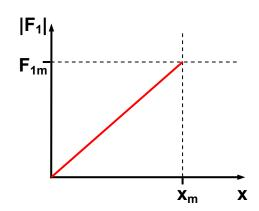
b) Damit die Kiste nicht verrutscht, darf die Maximalkraft F<sub>1m</sub> auf sie nicht größer als die maximale Haftreibungskraft F<sub>Hmax</sub> zwischen Kiste und Wagen werden. Es gilt :
