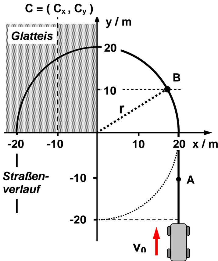
Ein Auto fährt mit konstanter Bahngeschwindigkeit  $v_0 = 45 \text{ km/h}$  auf einer horizontalen Straße, die eine U-Kurve mit Radius  $r$  beschreibt (siehe Skizze). Nach der Hälfte der Kurve beginnt ein Bereich, in dem Straße und Umgebung vollkommen von ideal glattem Eis bedeckt sind, Haft- und Gleitreibung zwischen Rädern und Eis sind hier gleich Null.
