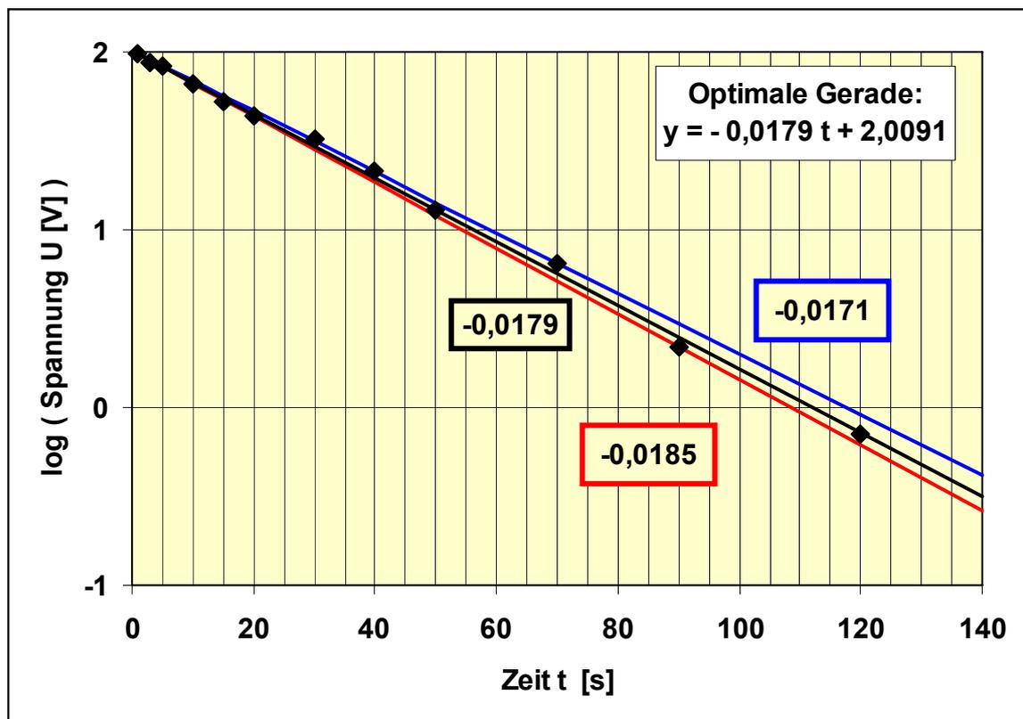
Auswertung des Diagramms ergibt für die Steigung der optimalen Geraden den Wert  $m_{\text{opt}} = -0,0179 \cdot \ln(10) = -0,04122 \text{ 1/s}$
