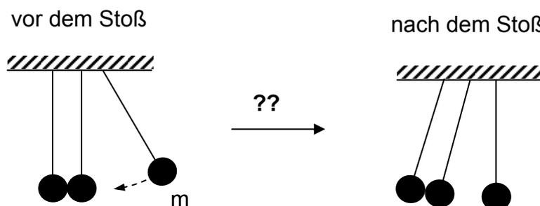
Zeigen Sie mit Hilfe des Energie- und Impulserhaltungssatzes, dass der in der rechten Bildhälfte skizzierte Zustand in Wirklichkeit nicht eintreten kann.
