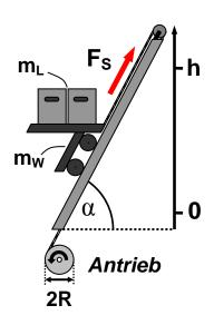
Auf einem um  $\alpha$  = 60° gegen die Horizontale geneigten Schrägaufzug befindet sich ein Wagen der Masse  $m_W$  = 25 kg. Haft- und Rollreibung des Wagens auf der Führung werden durch den gleichen Reibungskoeffizienten  $\mu$  = 0,1 beschrieben. Der Wagen wird über ein Seil bewegt, Masse und Reibung von Seil und Antrieb seien vernachlässigbar.
