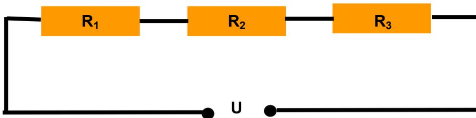
a) Da der Stromkreis aus einer einzigen Masche besteht, fließt der Gesamtstrom  $I$  und es gilt nach der Maschenregel
