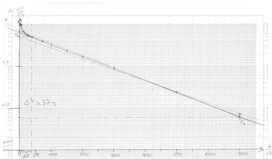
(b) Das Newtonsche Abkühlungsgesetz gilt in dem Zeitbereich, in dem die halblogarithmische Darstellung linear mit der Zeit verläuft, also durch eine Gerade dargestellt werden kann. Eine Abweichung vom linearen Verlauf zeigt sich zu Beginn der Messung im Zeitintervall von 0 s bis ca. 37 s.
