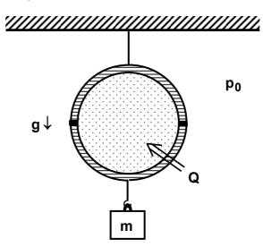
Zwei Halbkugelschalen aus Eisen (Dichte  $\rho=7,6\cdot10^3kg/m^3$ , s. Skizze) sind luftdicht aufeinandergelegt. In der Kugelschale befindet sich das Edelgas Helium mit der Temperatur  $\vartheta_1=20^0\,\mathrm{C}$  und dem Druck  $p_1$  gleich 1/10 des äußeren Luftdrucks  $p_0=1$  bar. Der Innendurchmesser der Kugel ist  $d_i=38,6$  cm und die Wandstärke beträgt 5 mm.
