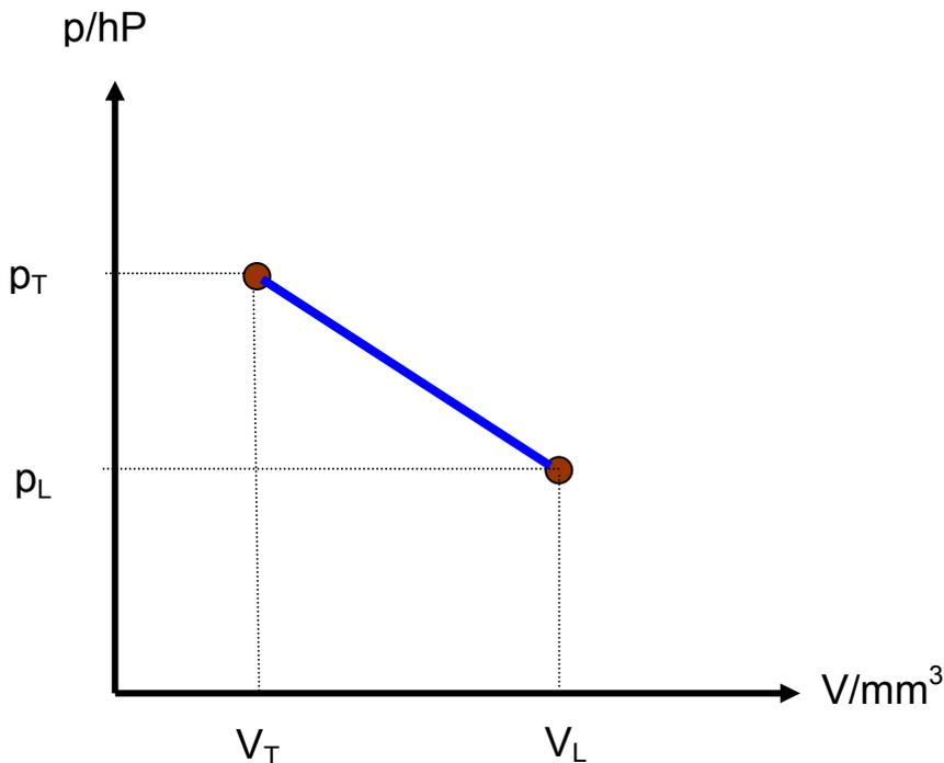
d) Beim Aufsteigen der Luftblase expandiert die Luft und die Arbeit  $W_{TL}$  wird von der Luftblase abgegeben, sie ist damit negativ.
