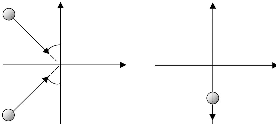
Zur Bestimmung der beiden unbekanntenen Größen - Betrag und Richtung der Geschwindigkeit des Körpers '2' – stehen die beiden Beziehungen der Impulserhaltungssatzes für die beiden kartesischen Komponenten zur Verfügung. Dazu kommen die in den Skizzen angegebenen geometrischen Bedingungen.
