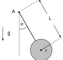
a) Berechnen Sie die Schwingungsdauer  $T_0$  für eine ungedämpfte Pendelbewegung bei kleinen Amplituden.
