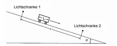
Die Beschleunigung a kann nun aus den Messwerten L, s, t<sub>1</sub> und t<sub>2</sub> bestimmt werden.
