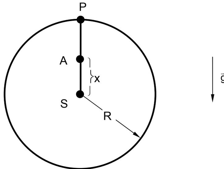
Das axiale Massenträgheitsmoment  $J_S$  der Scheibe bezüglich einer Achse senkrecht zur Scheibenebene durch den Schwerpunkt S ist  $J_S = \frac{1}{2} m R^2$ .
