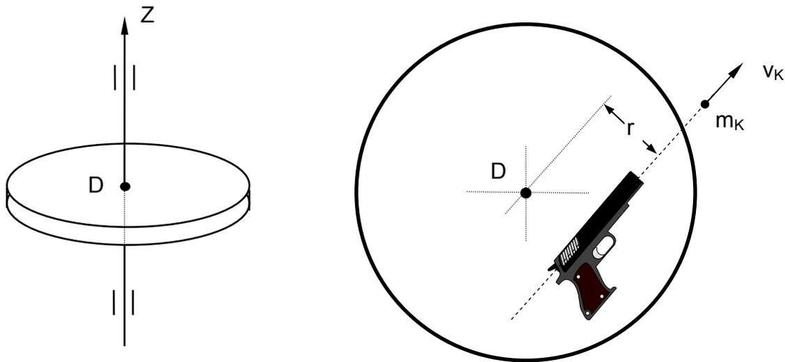
Das Massenträgheitsmoment von Scheibe und Pistole ohne Kugel bezüglich der Drehachse beträgt  $J_z = 0,02 \text{ kg m}^2$ .
