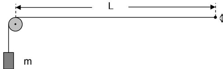
Am linken Ende hängt ein Körper der Masse  $m = 100 \text{ g}$ . Am rechten Ende ist die Saite in einer Halterung befestigt, die mit variabler Frequenz und sehr kleiner Amplitude auf und ab bewegt wird.
