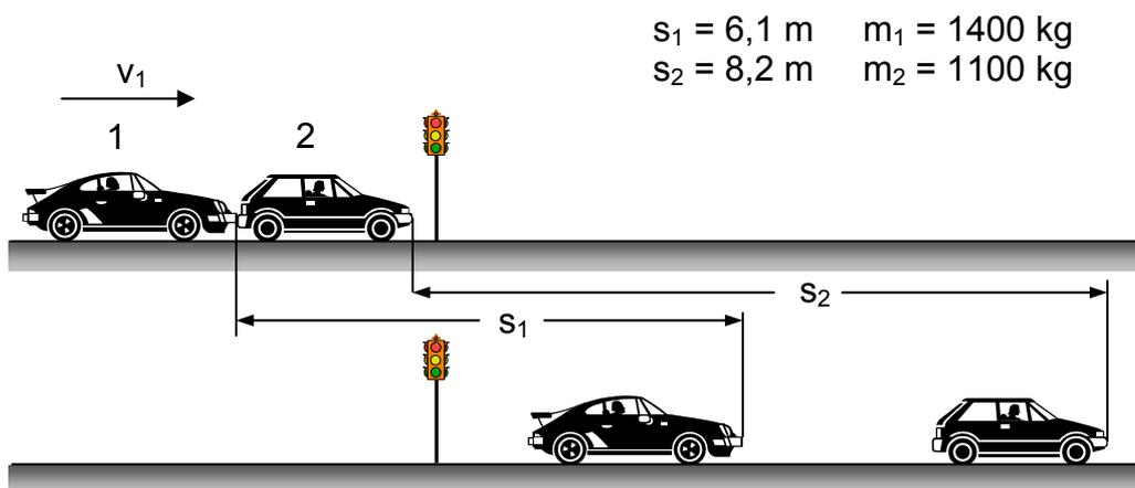
Die beiden Wagen trennen sich nach dem Zusammenstoß und rutschen mit blockierten Rädern die Strecken  $s_1$  bzw.  $s_2$  bis zum Stillstand. Der Gleitreibungskoeffizient  $\mu$  zwischen Fahrbahn und den vier Reifen beider Autos beträgt  $\mu = 0,13$ .
