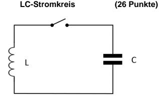
Ein Kondensator ( $C = 1 \mu F$ ), eine Spule ( $L = 10 \mu H$ ) und ein Schalter sind entsprechend des Schaltbildes miteinander verbunden (siehe Abbildung). Zu Beginn (t = 0 s) ist der Kondensator auf die Spannung U(0) = 10 V geladen und der Schalter ist offen. Durch Schließen des Schalters entlädt sich der Kondensator über die Spule.
