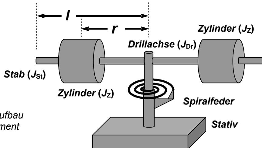
Abb. 1 : Versuchsaufbau
